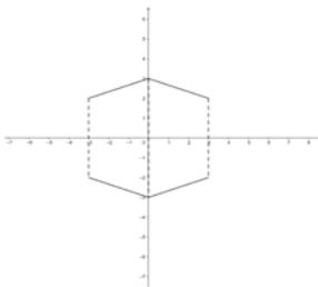
En remplaçant  $f$  par une fonction affine par morceaux, on retrouve la formule de Kepler.
